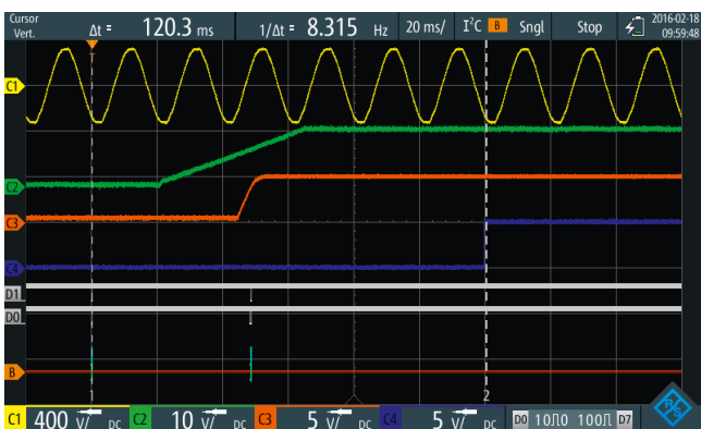
PMBus/I 2 Cコマンドによる組込型AC/DCコンバータの立ち上がり信号
